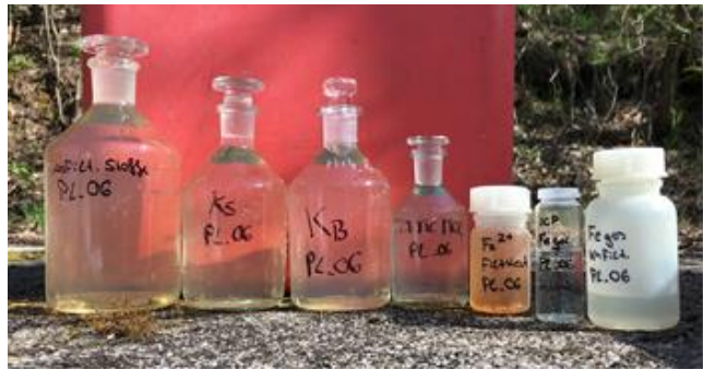
Abb. 2-2: Probenkonservierung vor Ort
